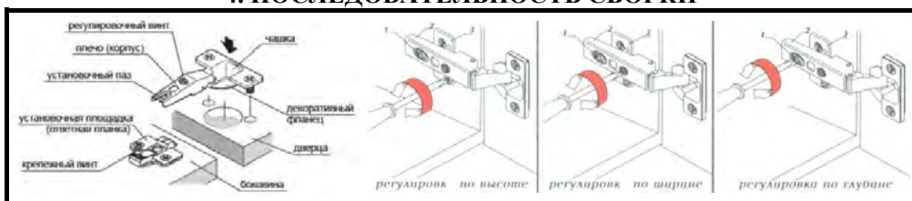
Рис. 1 Установка петель (установка на саморезы 4x16 мм)
