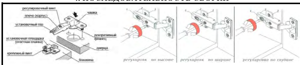
Рис. 1 Установка петель (установка на саморезы 4x16 мм)
