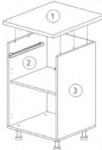
12. Соедините деталь 1 с деталями 2, 3 с помощью уголков пластиковых и саморезов 4x16 мм, 4x25 мм.
