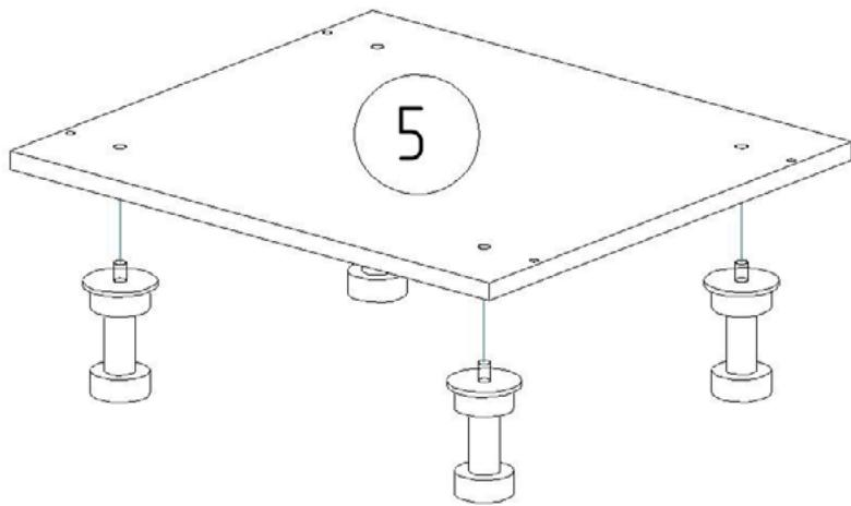
7. Установите на деталь 5 опоры с помощью саморезов 4x16 мм.
