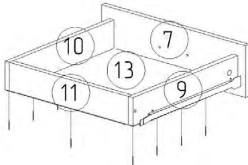
5. Установите деталь 13 в паз детали 7, закрепите ее с помощью гвоздей 1,4x25 мм на торцах деталей 9, 10, 11.
