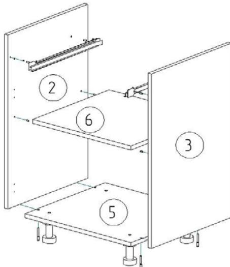
8. Установите на детали 2, 3 полкодержатели, после окончательной сборки установите на них деталь 6.
