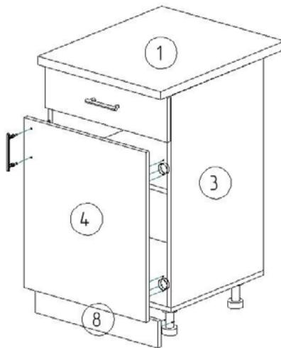
13. Установите на деталь 8 клипсы + планки, планки закрепите с помощью саморезов 4x16 мм, затем защелкните клипсы на опорах.
