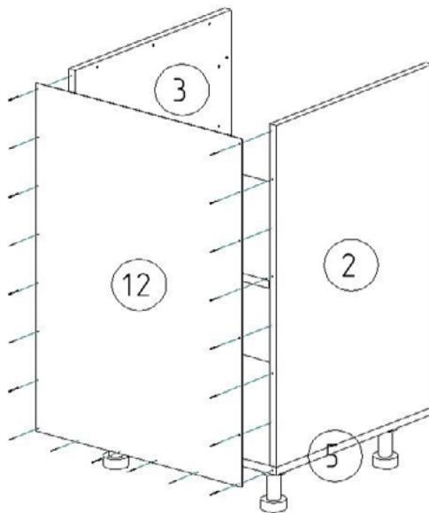
11. Закрепите деталь 12 на каркасе тумбы с помощью гвоздей 1,4x25 мм.
