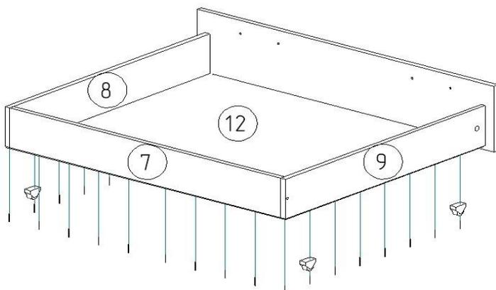
5. Установите деталь 12 в паз детали 2, закрепите ее с помощью гвоздей 2,0x25 мм на торцах деталей 7, 8, 9, а на деталь 2 закрепите уголками мебельными и саморезами 3,5x20 мм (4 уголка).
