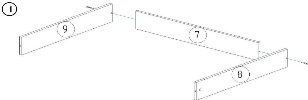
1. Соедините детали 7, 8, 9 с помощью винтов евро 7x50 мм.
