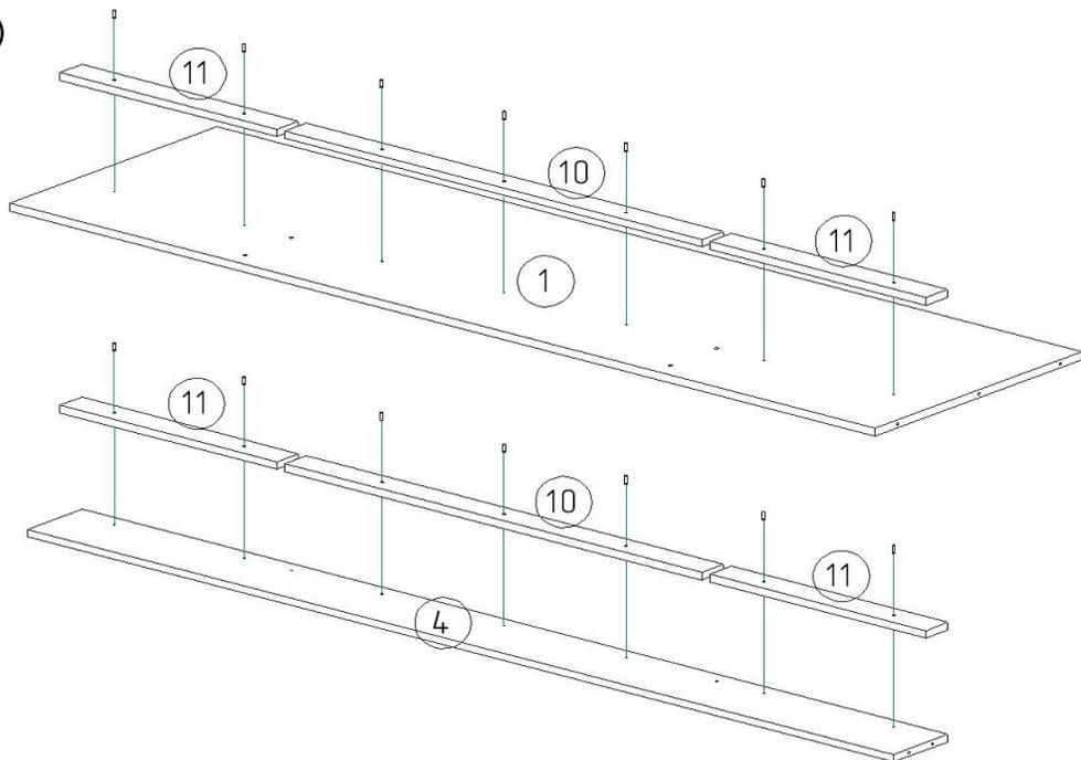
8. Соедините деталь 1 с деталями 10, 11 и деталь 4 с деталями 10, 11 с помощью саморезов 4х30мм.
