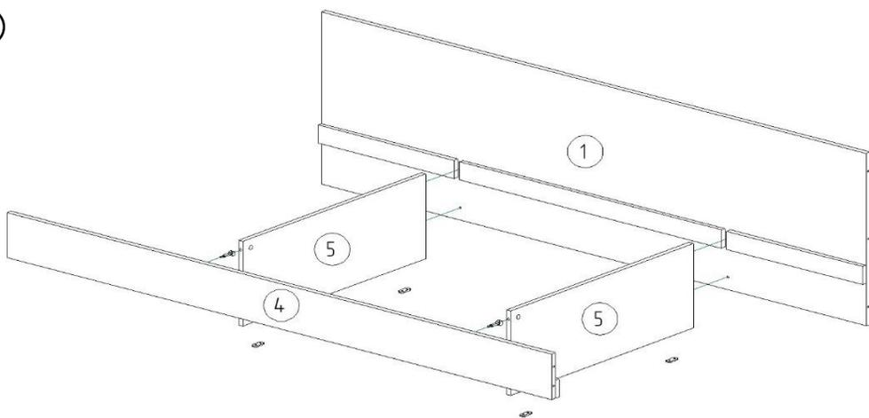
9. Установите на детали 5 подпятники с помощью гвоздей 2,0х25 мм.
