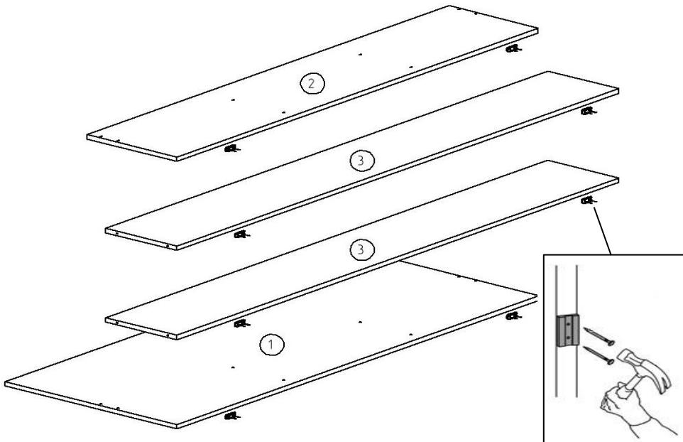
3. Установите на детали 1, 2, 3 подпятники с помощью гвоздей 2,0х25 мм.
