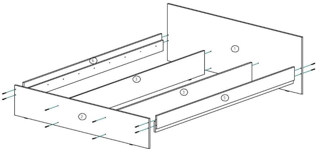
4. Соедините детали 3, 5, 6 и детали 1, 2 с помощью винтов евро 7x50 мм.
