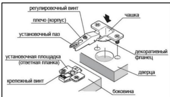
Рис. 2 Установка петель (установка на саморезы 4x16 мм)
