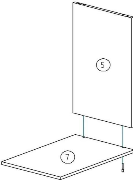
8. Соедините детали 5, 7 с помощью винтов евро 7x50 мм.
