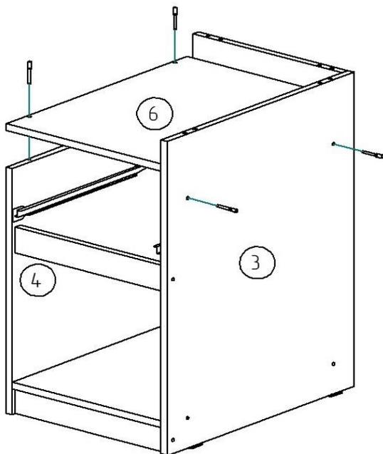
11. Соедините детали 3, 4, 6 с помощью винтов евро 7x50 мм.
