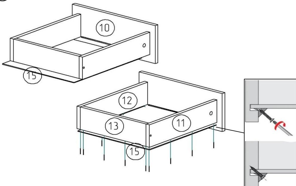
4. Установите деталь 15 в паз детали 10, закрепите ее с помощью гвоздей 2,0x25 мм на торцах деталей 11, 12, 13, а на деталь 10 - закрепите уголками мебельными и саморезами 3,5x20 мм (по 2 уголка на фасад).
