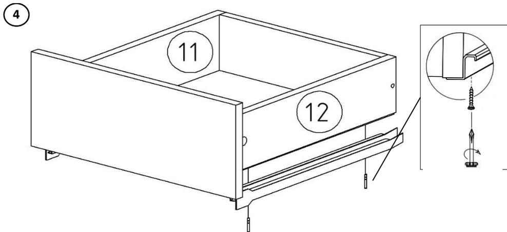
5. Закрепите направляющие роликовые с помощью саморезов 4x25 мм на деталях 11, 12.
