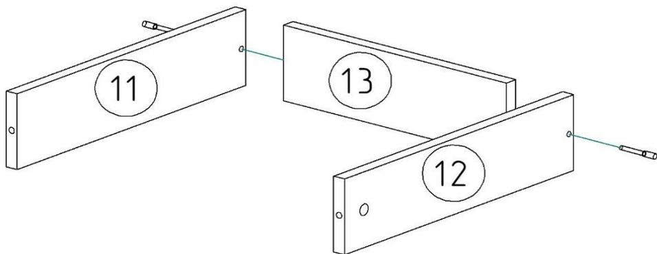
1. Соедините детали 11, 12, 13 с помощью винтов евро 7x50 мм.
