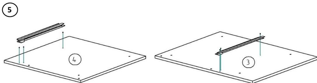
7. Установите на детали 3, 4 направляющие роликовые с помощью саморезов 3,5x16 мм.
