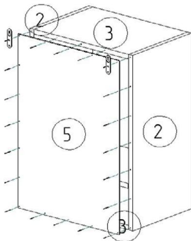
3. Закрепите деталь 5 на каркасе шкафа с помощью гвоздей 1,4x25 мм.
