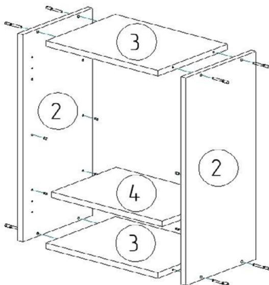
1. Соедините детали 2, 3 с помощью винтов евро 7x50 мм.
