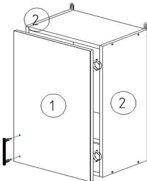
5. Закрепите ответные планки петель на деталь 2 (зависит от открывания фасада) и петли накладные на деталь 1 с помощью саморезов 4x16 мм.
