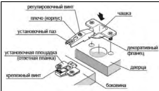
Рис. 1 Установка петель (установка на саморезы 4x16 мм)
