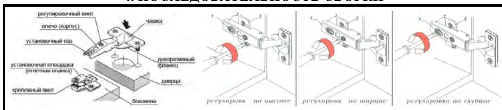
Рис. 1 Установка петель (установка на саморезы 4x16 мм)
