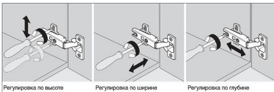
Рис. 1 Установка петель (установка на саморезы 4x16 мм)
