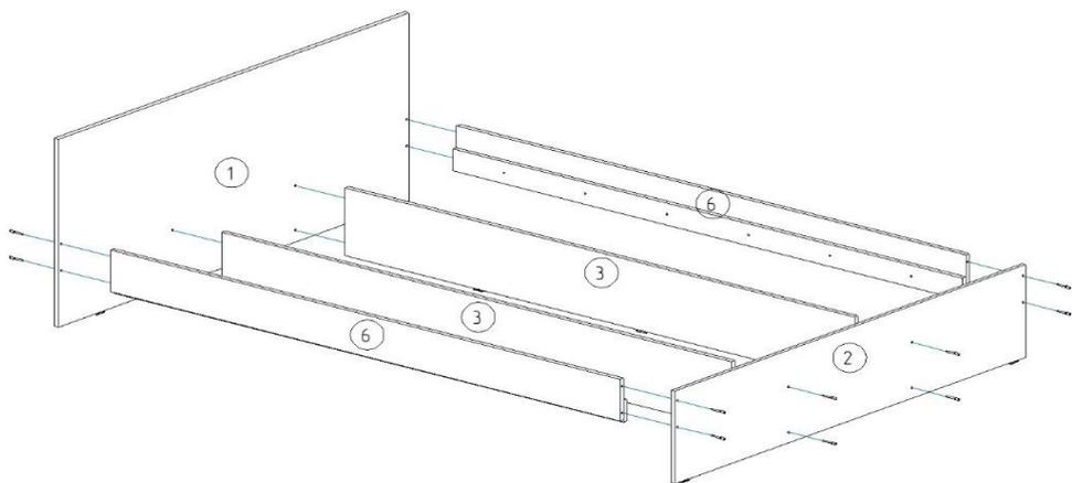
4. Соедините детали 3, 6 и детали 1, 2 с помощью винтов евро 7x50 мм.
